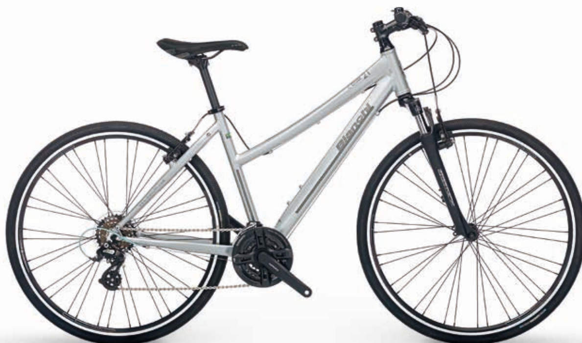
CAMALEONTE C-SPORT CROSS ALU LADY ALTUS 3X7SP V-BRAKE - 35MM TIRE CODICE: YLBB5 | COLORE: D4 - Argento, grafite/bianco matt
